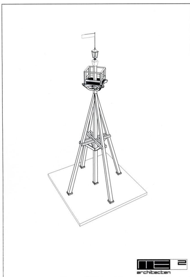
Afbeelding: ontwerptekening van het nieuwe havenlicht. Op de tekening heeft de lamp de vorm van een ouderwetse lantaarn. Dit is niet gerealiseerd. (Stichting Stadsherstel Medemblik)
